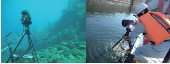
図3 三脚による計測方法
