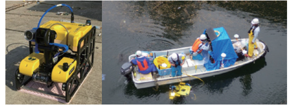
図5 ROVを用いた計測方法
